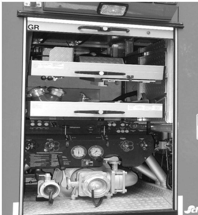
Pumpen - Bedienfeld Löschfahrzeug
